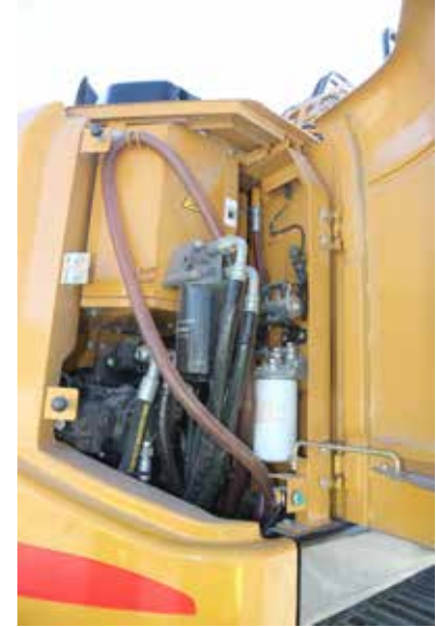
HYDRAULIPUMPPU JA osa suodattimista on sijoitettu koneen takakulmaan luukun taakse.
